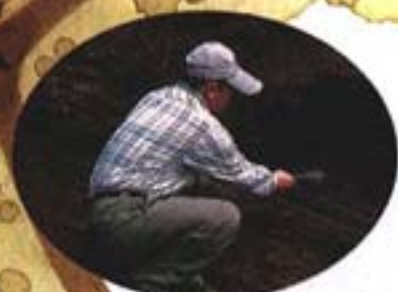
②登山者が持ち歩く鉄鍬は柔らかい層を見るときに使用。ほかにハンマーやスコップも携帯しています
