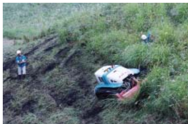
草丈約1.5mの急斜面を遠隔操作で刈っていく。深い草の中にはオペレーター補助がおり誘導する。
