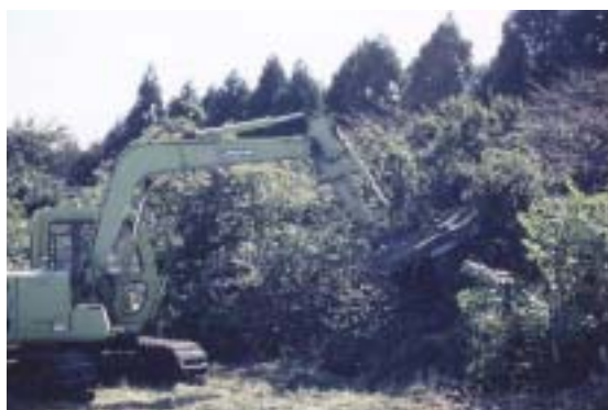
背丈の高い灌木類は木の上までアームを伸ばし、押しつぶすように刈る
